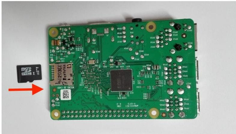
Electronic assembly: inserire la micro-SD card nel Raspberry Pi – spingere la micro-SD nello slot connettore fino a quando si sentirà il suono "click".
